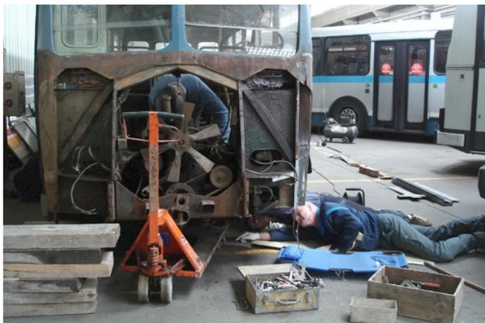
Mais le plus important chantier sur ce véhicule est bien le remplacement du moteur d'origine qui était à essence (un Hotchkiss) par un Diesel Panhard 4 HL (photo en bas de la colonne de gauche : dépose du moteur Hotchkiss).
