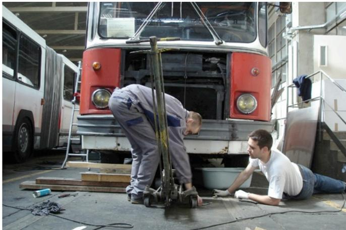
En ce qui concerne la carrosserie et l'aménagement intérieur, la vitre qui était cassée (entre les portes avant et médiane) a été remplacée. Le coffre à batteries a été restauré. Trois vantaux de portes seront prochainement changés et enfin les sièges sont en cours de remplacement avec des éléments que nos amis Toulousains de l'association ASPTUIT, Jérôme et Michaël, nous avaient récupéré sur des SC 10 de leur réseau qui étaient réformés (merci à eux).
